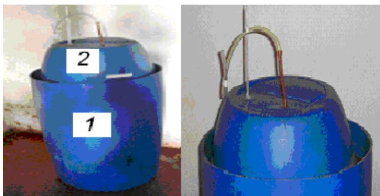
Figura 1 – Biodigestor (1) e gasômetro (2) em bombonas plásticas, dotado de termômetro e orifício para saída de biogás.
